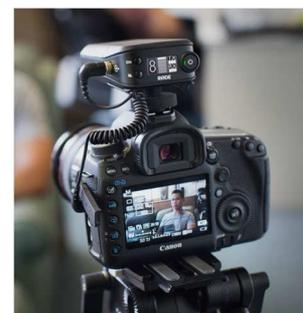
Der Empfänger wird auf den Blitzschuh gesteckt und über das beiliegende Spiralkabel mit der Kamera verbunden.
